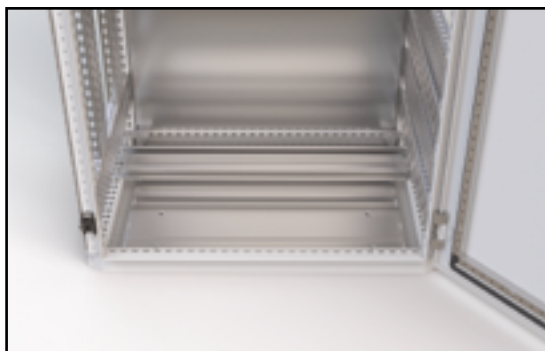
50mm prostor od země ke spodní hraně dveří umožní instalaci rozvaděče bez podstavce díky speciálně navrženému spodnímu rámu. Toto řešení nezmenšuje prostor pro vnitřní instalace.
