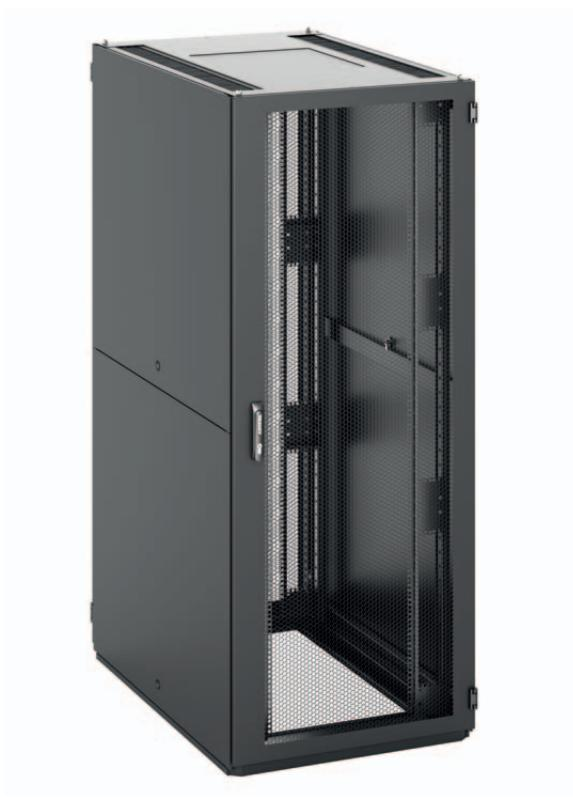
**Le plateau supérieur en une seule pièce comporte** des ouvertures équipées de brosses en plastique des deux côtés pour une installation flexible du câblage. L'ouverture pour l'unité de ventilation est recouverte d'un panneau de tôle vierge. Les panneaux latéraux présentent des séparations horizontales pour faciliter la manipulation et sont protégés par un verrou empêchant tout accès non autorisé.
